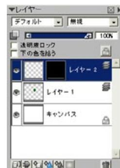
新規作成したレイヤーに対して、「透明度からレイヤーマスク作成」でレイヤーマスクを作成する。
